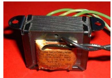
El transformador es un dispositivo que convierte la energía eléctrica alterna de un cierto nivel de tensión, en energía alterna de otro nivel de tensión, basándose en el fenómeno de la inducción electromagnética. Está constituido por dos bobinas de material conductor, devanadas sobre un núcleo cerrado de material ferromagnético, pero aisladas entre sí eléctricamente. La única conexión entre las bobinas la constituye el flujo magnético común
