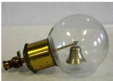
Una campana encerrada en un bulbo al vacío, NO puede transmitir ondas de sonido
